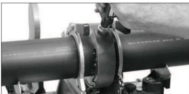
Srovnání konců potrubí integrovaným hoblíkem
