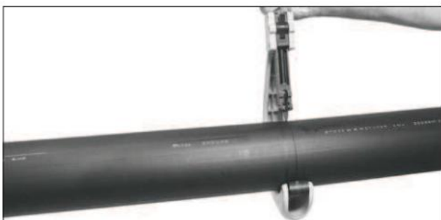
Řez potrubí ruční rotační řezačkou
