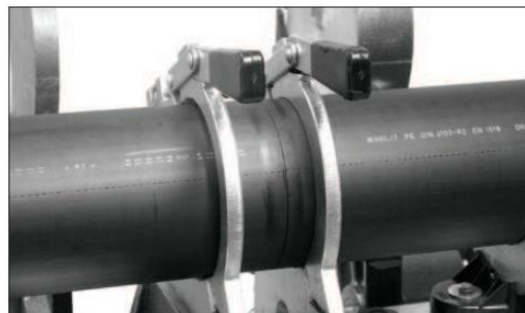
Správně připravené potrubí ke svařování
