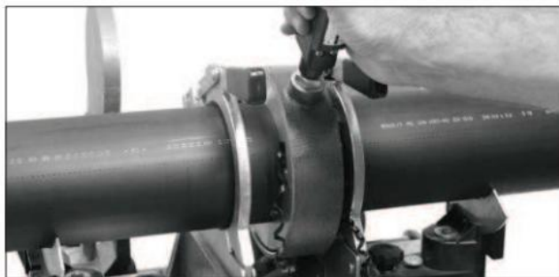
Srovnání konců potrubí integrovaným hoblíkem
