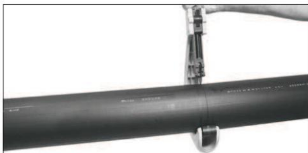
Řez potrubí ruční rotační řezačkou
