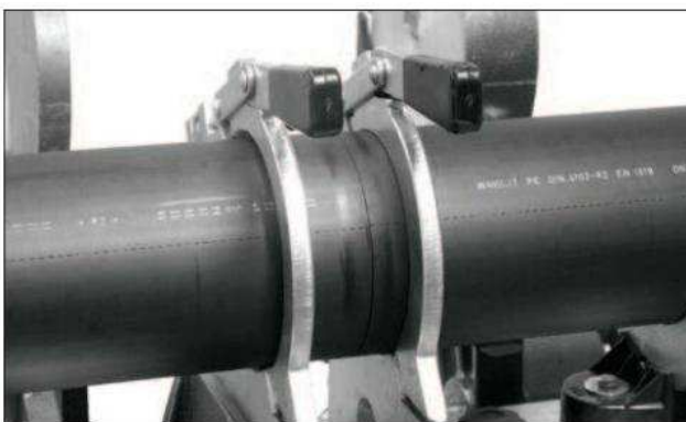
Správně připravené potrubí ke svařování
