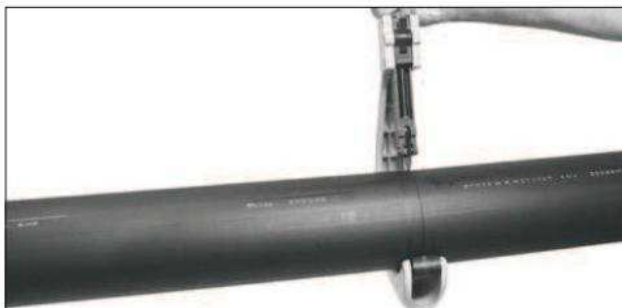
Řez potrubí ruční rotační řezačkou
