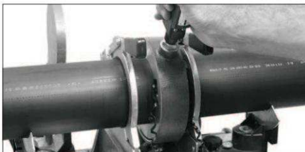
Srovnání konců potrubí integrovaným hoblíkem
